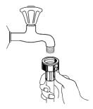
Koneksikan selang penyedia air dingin ke konektor berulir 3/4 (inci) dan pastikan sudah terpasang dengan kencang pada tempatnya. Jika pipa air baru atau sudah lama tidak digunakan, biarkan air mengalir untuk memastikan air bersih dan bebas dari kotoran. Jika tindakan pencegahan ini tidak dilakukan, terdapat risiko saluran masuk air tersumbat dan dapat merusak peralatan.
