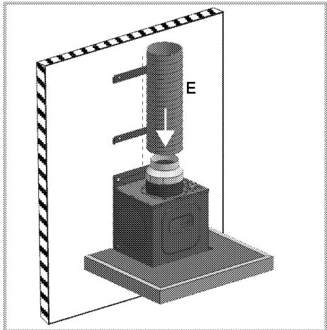
Asegúrese de que los tubos de conexión de la chimenea sean de material plástico ignífugo. Al usar una tubería de conexión flexible, debe tenerse en cuenta que las esquinas pronunciadas y las contracciones súbitas tendrán un efecto negativo sobre la succión de aire.
