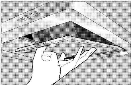
11. Instale el filtro de carbono tal como se muestra en la siguiente imagen.
