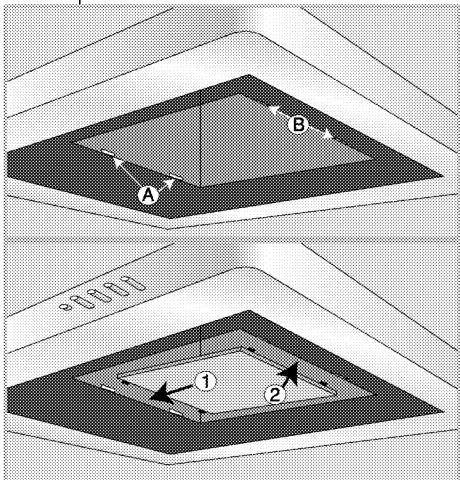
3. Inserte las puntas largas y rígidas del otro lado del filtro de carbono en la ranura B en la dirección 2.
